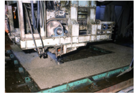
コンクリートパネルを工場生産。
