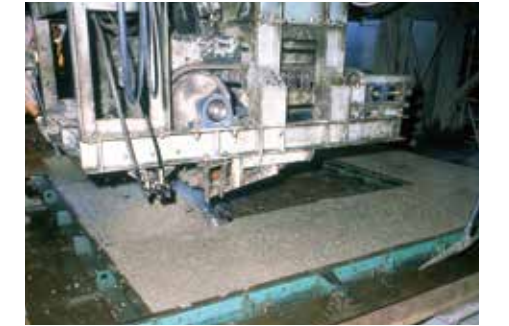
コンクリートパネルを工場生産。
